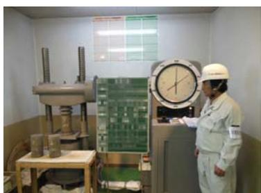
④圧縮強度試験確認状況
